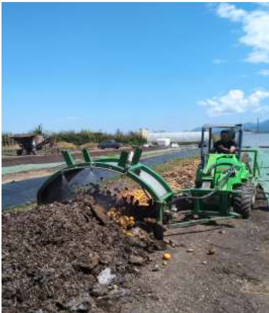
Εικόνα 4. Εξάρτητα αναστροφής. Η ταχύτητα του τρακτέρ είναι έρπουσα..
